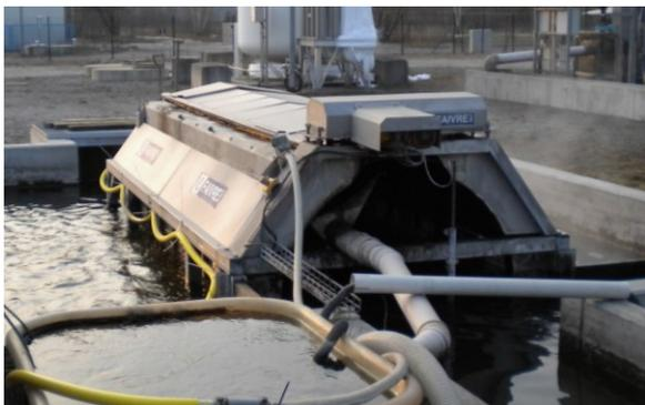
Abbildung 9: Trommelfilter entfernen sehr effektiv Feststoffe aus dem Kreislauf.
