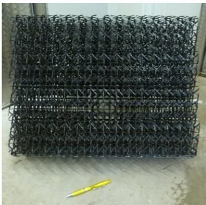
Abbildung 10: Starres Trägermaterial für den Biofilm im Biofilter.
